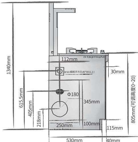
燃气管、烟管电源线开孔尺寸
