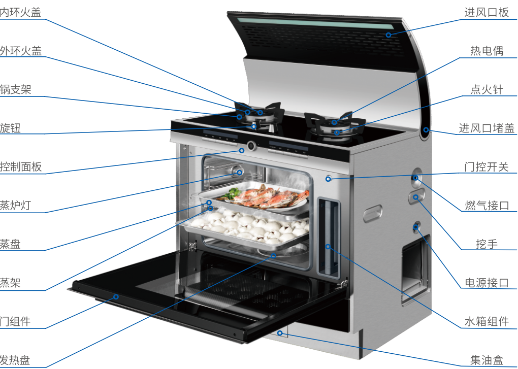
双气玻璃款(蒸炉)结构示意图
